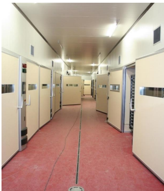
Abbildung 6: In Großbrütereien werden Vor- und Schlupfbrut räumlich getrennt, um die notwendige Hygiene zu gewährleisten. Vor jeder Brut ist eine gründliche Desinfizierung notwendig.
