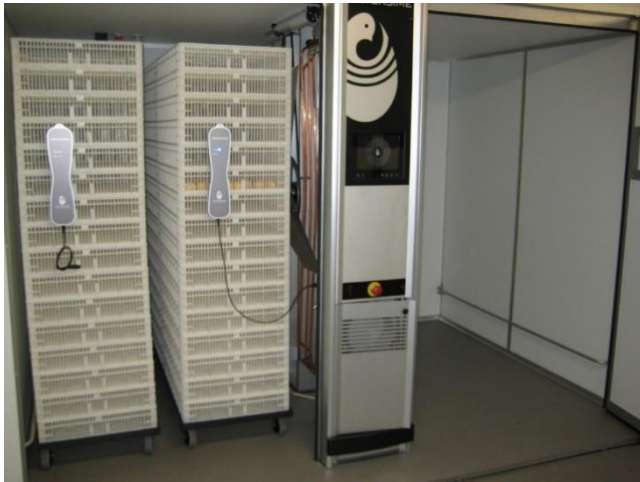
Abbildung 4: Schlupfbrüter in Großbrütereien mit modernster Klimaregelung.
